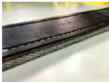
Protección del cuerpo de la eslinga con banda encauchetada
