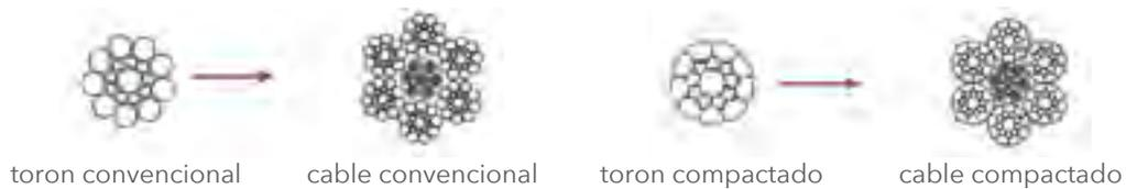
El torón compactado tiene condiciones de contacto interno muy favorables en comparación con el contacto puntual de alambres redondos dentro de un torón normal.
