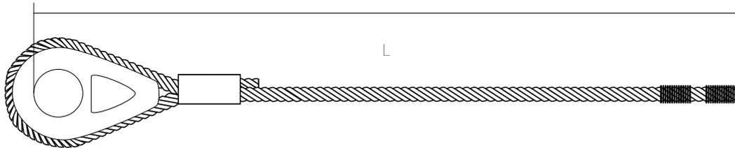
Prensamos eslingas de "ojo doblado" con férulas de aluminio bajo las especificaciones de la norma EN 13411-3. Este tipo de prensado de ojo y férulas permite utilizar cables anti-giro como lo es el 19X7 o 35X7 de alambre redondo y también compactado.
